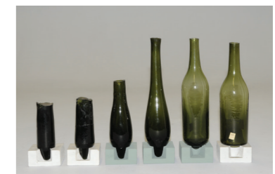
Étapes de fabrication d'une bouteille à champagne, vers 1854.
